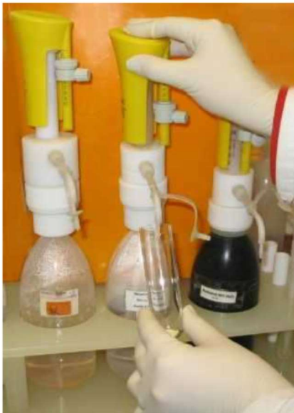
การเติมสารเคมี (Dosing station)
